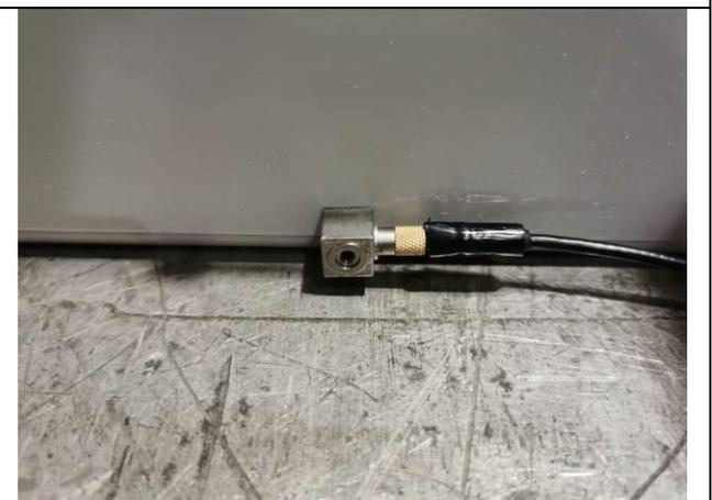
序号 4-6 加速度传感器安装位置 (底部)
