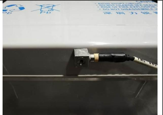
序号 4-8 加速度传感器安装位置 (顶部)
